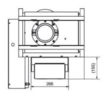
die Bedieneinheit kann am Rahmen montiert werden
